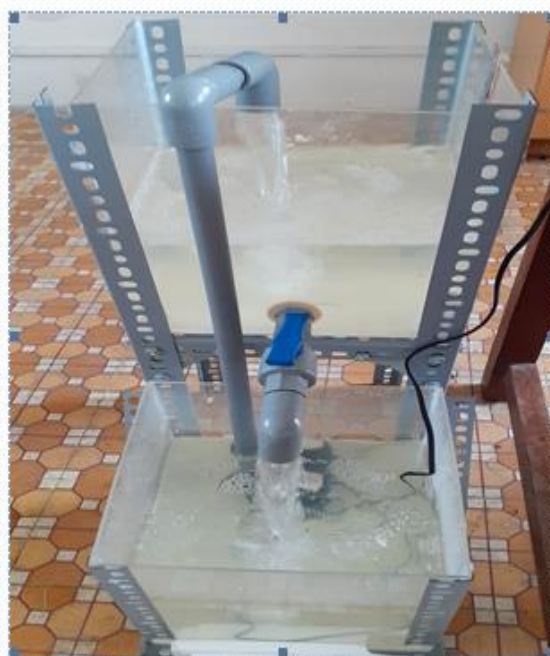
Hình 8. Mô hình bơm nước tự động hoàn chỉnh.
